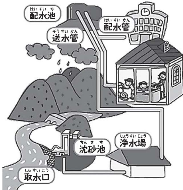
銚子市の東の地域は、東庄町にある新宿取水場で黒部川の水を取水して本城浄水場へ送り、浄水処理した水を高台にある配水池に送って、みんなに水を届けているよ。
