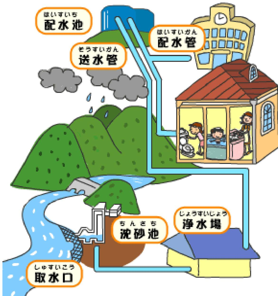
銚子市の東の地域は、東庄町にある新宿取水場で黒部川の水を取水して本城浄水場へ送り、浄水処理した水を高台にある配水池に送って、みんなに水を届けているちょ。
