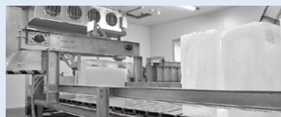
▲(上)銚子漁協海水氷製氷工場と(下)同製氷工場(第3卸売市場)。角氷を粉砕する機械
